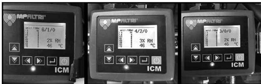
図6 セルロース毛細管フィルターを活用した浄油により、NAS0級相当の清浄度を達成
